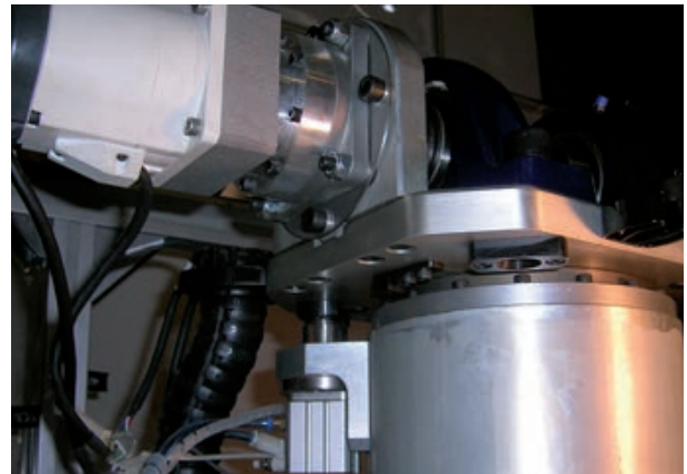
PRT-01-100 回转环轴承用于自动焊接装置, 用于此种类型运用中, 可使夹紧装置在同一平面中做旋转。
